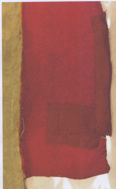
Bilder 6 och 7. Strumpans förslutande söm öppnad, underlagning av strumpan och förberedelser för cerepelinlaminering.
